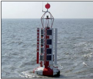
Marca de aguas navegables con su característico tope rojo y esférico
