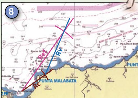
7 Y con el compás tomamos la medida del vector  $R_v$  para obtener la  $V_m$  en la escala de latitudes.  $V_m = 5'$ . **Contrarrestar el abatimiento:** 8 Una vez resuelto el triángulo de vectores, toca ahora ocuparse de contrarrestar el abatimiento de  $14^\circ$  que nos provoca el fuerte viento de Levante. Para ello...
